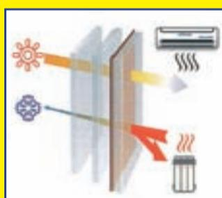
Специальное тепло-сберегающее напыление и терморамка значительно повышают теплосбережение по сравнению с обычным окном и снижают риск возникновения конденсата.
